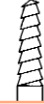
Träger mit Holzschraubengewinde, konisch mandrel with external thread, conical mandril con rosca, cónico
